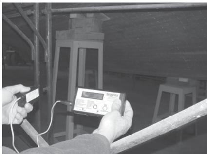
La misurazione con la sonda "LASER" -optional dello SKINDER- per misurare la temperatura superficiale di una carena e del materiale da applicare.
