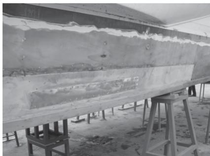
Il numero delle mani è in proporzione allo spessore del film, ma è importante che il quantitativo applicato di C-Systems 10 10 CFS corrisponda a 600-700 gr. per metro quadrato a lavoro terminato, il che significa circa 6-7 litri ogni 10 metri quadrati di superficie.
