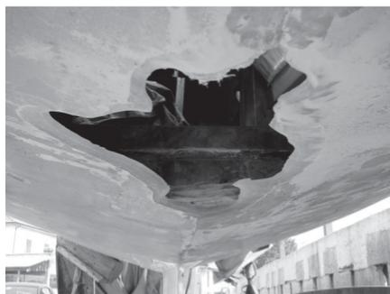
Qui il danno non era l'osmosi ma i tessuti che non toccavano perché aggrinzati e filtravano acqua sotto il motore. È stato un piacere vedere poi il risultato conseguito.
