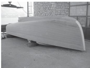
Un bellissimo scafo di oltre 7 metri, a clinker, pronto per essere girato e passare alla fase degli interni e verniciatura.
