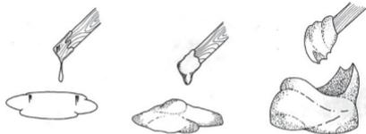
C-Systems 10 10 CFS A+B, con un quantitativo medio di additivo e poi fortemente inspessito per fare filetti laterali e restare in verticale.
