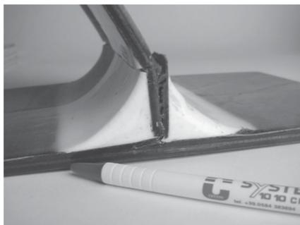
Compensato WBP di ottima produzione nazionale incollato a T rovesciato con i filetti laterali fatti con C-Systems 10 10 CFS e Microfiller Powder. Sotto trazione... tronca il compensato verticale e delamina quello orizzontale.
